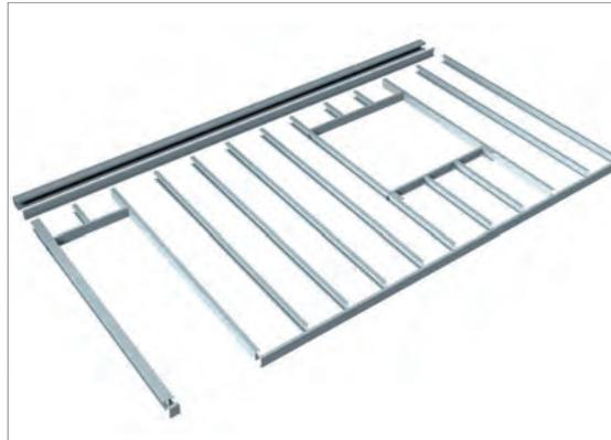
Luego se procede a fijar, desde la solera inferior, cada una de las piezas, con dos tornillos en cada empalme; el tornillo a utilizar para la unión debe ser 10 x 5/8, cabeza de lenteja y punta broca.
