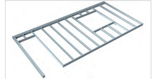
Una vez completada la unión de los elementos, se verifica su **ortogonalidad** (cuadratura del panel) mediante las diagonales como se muestra en la figura. Ello se lleva a cabo con la ayuda de la hinchita de medir metálica. La diferencia de medida (tolerancia) no puede ser mayor de 3 mm.
