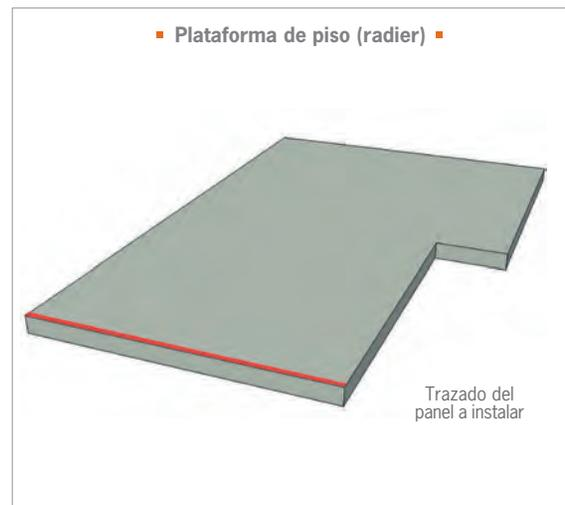
Se inicia el montaje trazando los muros en la plataforma de piso, para proceder al montaje del primer panel.
